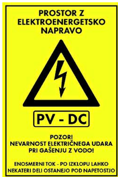
Slika 3: Nalepka za stikalni blok SB-DC
