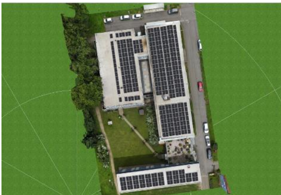
Slika 1: Razporeditev FV modulov
